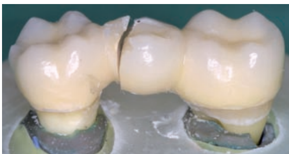
Abb. 11: Brücke nach Kausimulation und Bestimmung der Rest-Festigkeit (Uni Regensburg).
