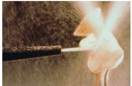
Abb. 3: Das Abstrahlen der Oxidkeramik (auf der Kroneninnenseite) mit Aluminiumoxidkorn vergrößert die Haftoberfläche für die Befestigungsmedien. Foto: 3M Espe
